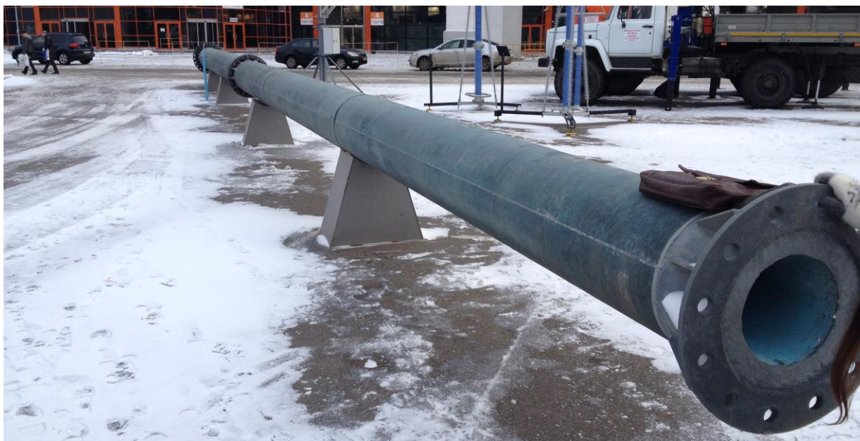
Рис. 4. Железобетонная центрифугированная секционированная стойка на выставке «Электрические сети России-2013»
