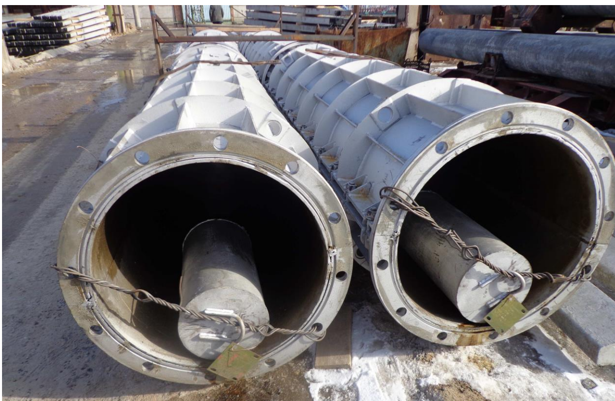
Рис. 3. Металлоформы для изготовления железобетонных центрифугированных секций диаметром 800 мм на заводе «Рыбинскэнергожелезобетон», г. Рыбинск
