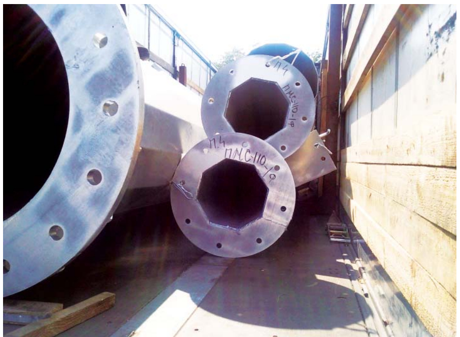
Рис. 3. Так до недавнего времени загружали секции СМО для перевозки на одном из отечественных заводов
