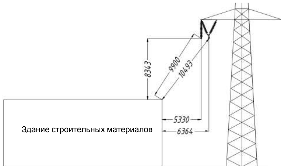
Рис. 3. Смещение крайней фазы на опоре П23М
