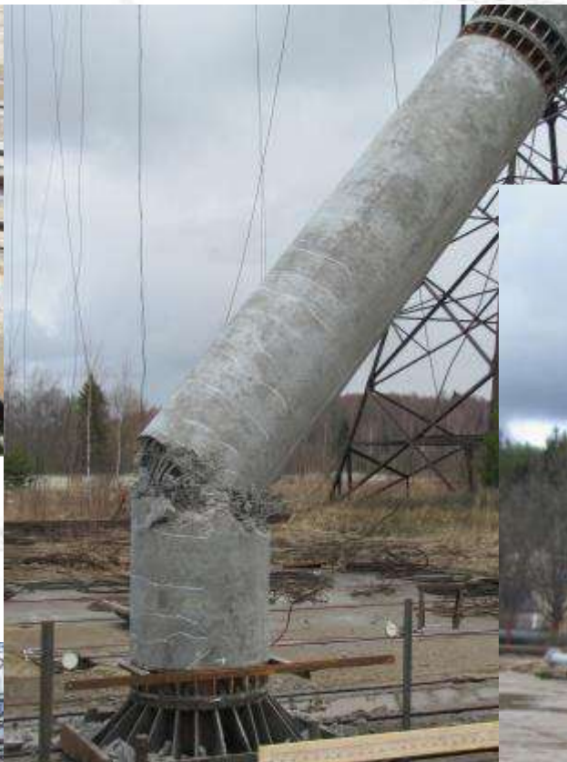
Разрушение стойки СЦС20 В60.1 (160%)
