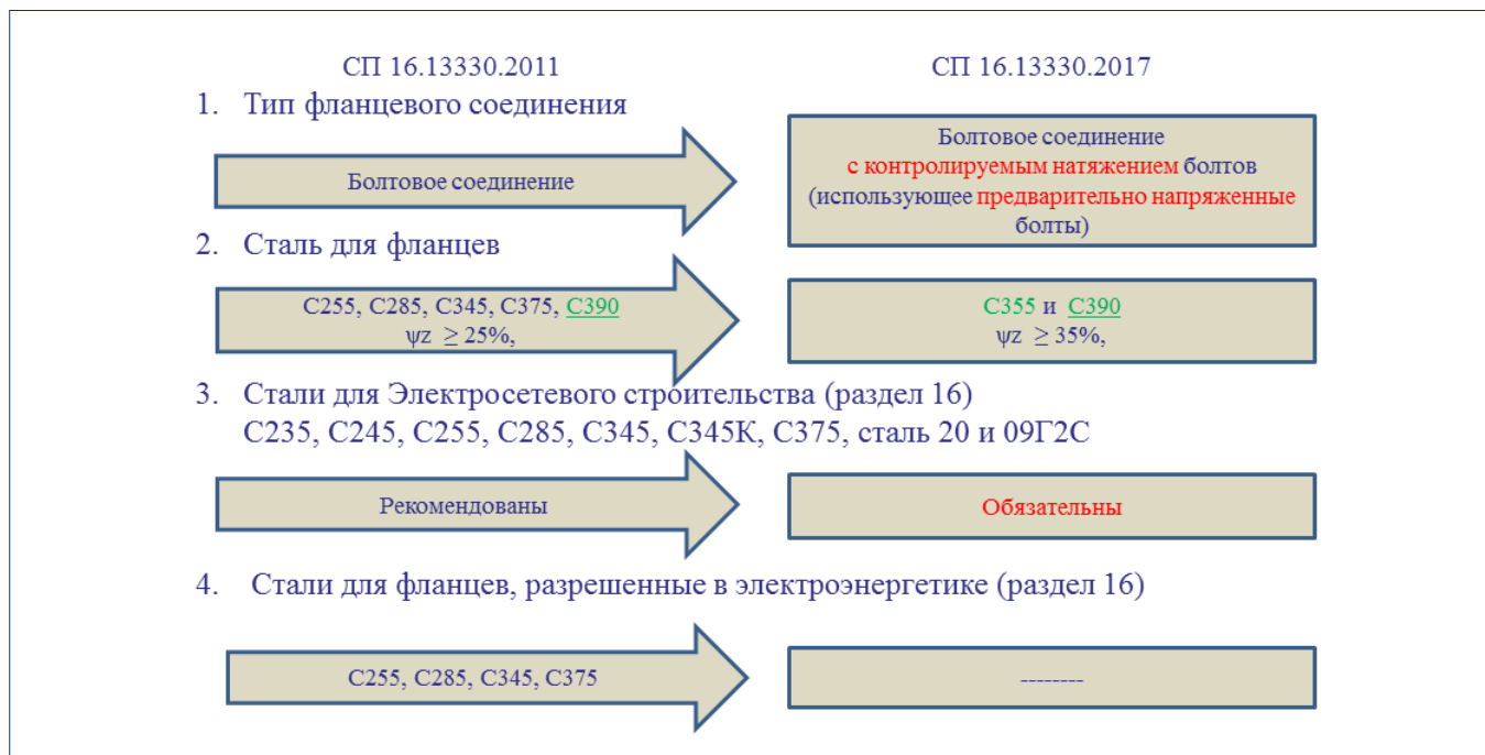
Рис. 4. Требования к фланцам в СП 16.13330.2017 в сравнении с СП 16.13330.2011
