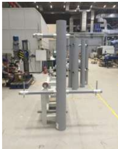
Верхняя секция ПК10-2. Контрольная сборка
