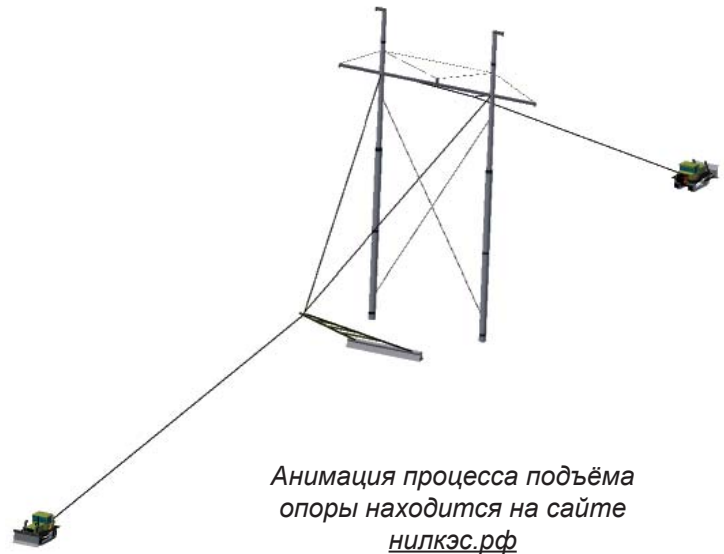
Рис. 4. Процесс подъёма опоры
