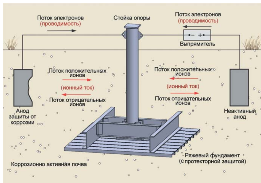
Принципиальная схема систем катодной защиты с активными (гальваническая защита) и неактивными анодами (защита с наложенным током).
