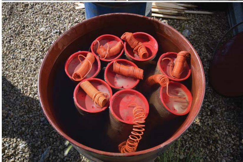
Магниевые аноды предпочтительны к использованию в катодных защитах фундаментов питающих и распределительных линий электропередачи. Для анодов в засыпке предполагается применение специального заполнителя в целях повышения их эффективности.
